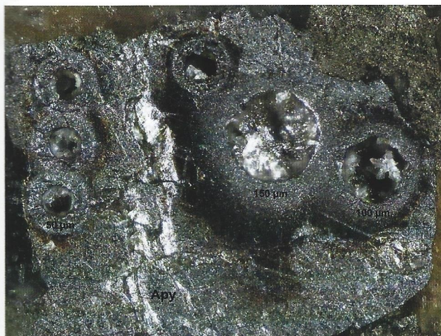
Abb. 23 Probe 005. Arsenkies-Einkristall in Matrix. Kratergrößen der Laser-Ablation: Serie B, links: 50 µm. Serie A, rechts: 50 µm, 150 µm und 100 µm
